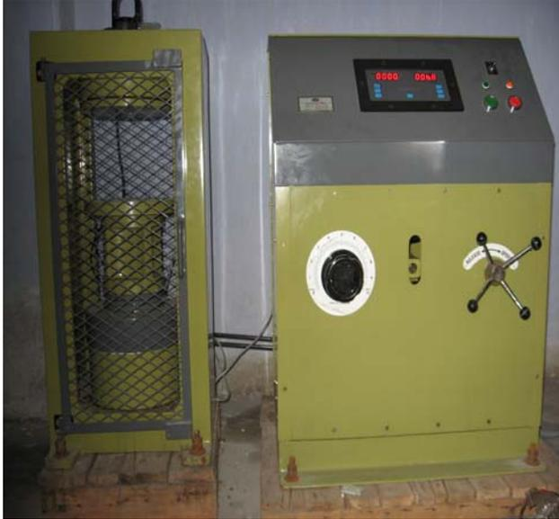
Fig. 10. Hydraulic press (120 Ton).
